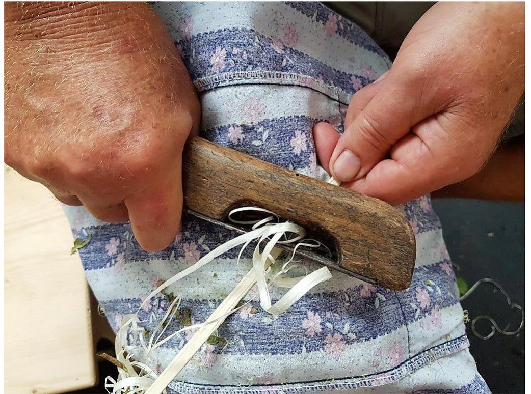
...dann die Feinarbeit mit Messer und einer Art Hobel, bis das Band gleichmäßig dünn ist und leicht gebogen werden kann, ohne zu brechen
